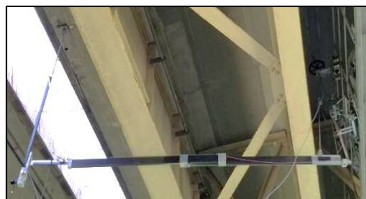
写真-1 ロッドタイプ検査装置の全景
