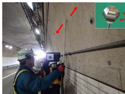
図－1 回転式打音点検器 (パソコン版 S-SJ 検証状況)
