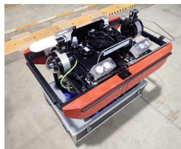
写真-1 栈橋上部工点検用 ROV
