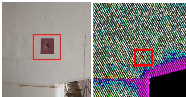
図-5 case3 検出可 (左：実構造物 右：コンター図)
