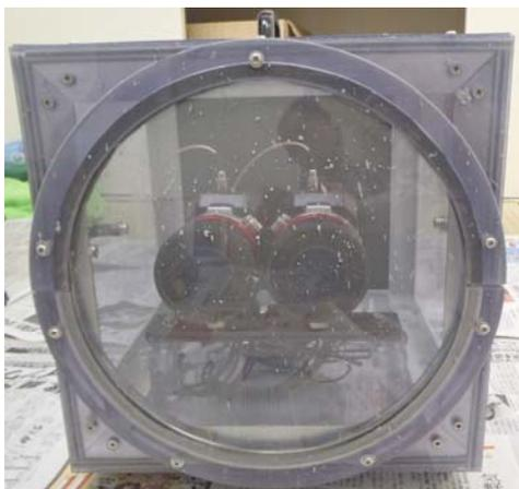
図-8 吹付作業後のカメラボックス状況
