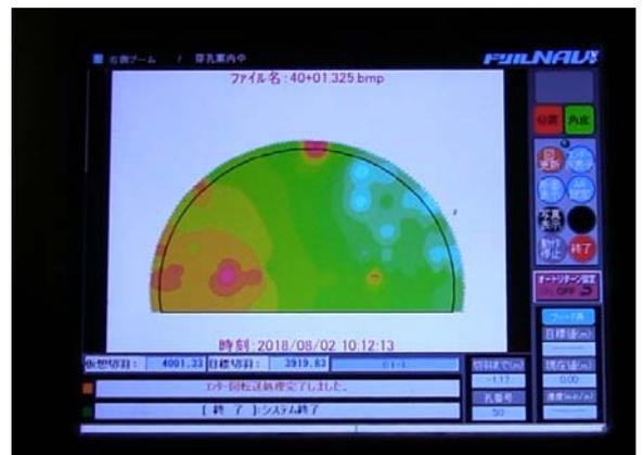
(b) 地山硬軟（削孔エネルギー）の確認
