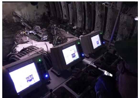
図-2 ジャンボキャビン上のガイダンス用モニター
