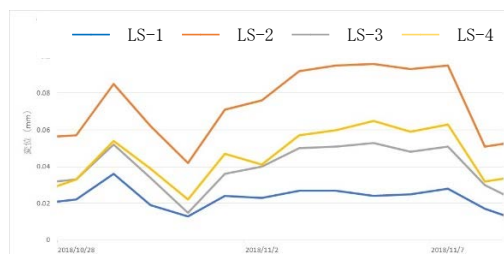
図-3(a) トラス主構の長さ変化量
