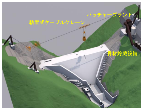
図-1 軌索式ケーブルクレーン配置図
