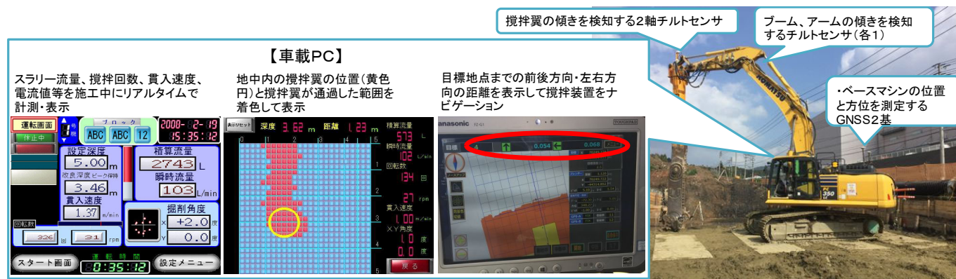
図－1 ICT地盤改良機械の一例
