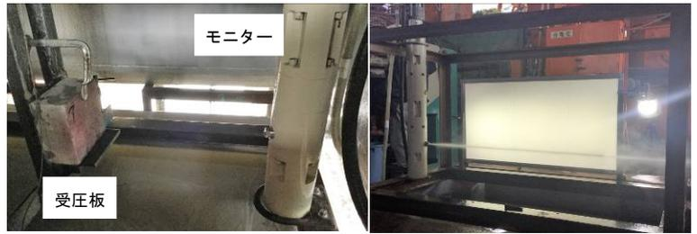
写真1 噴射試験状況 (左: 受圧板切削 右: 高速度カメラ撮影)
