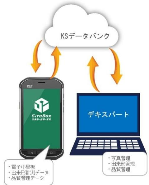
図-1 施工管理システムのイメージ
