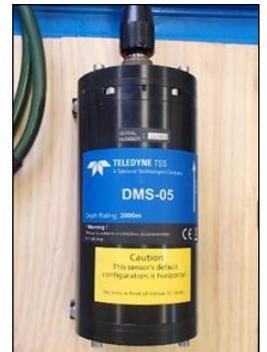
図-2 動揺補正装置
