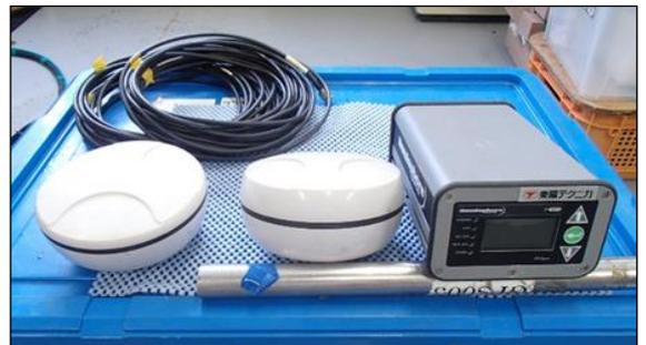
図-3 GNSS 測位機と方位計
