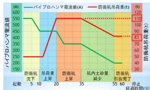
図6 防衛杭撤去時の計測値の変化
