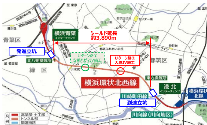
図 1 横浜環状北西線平面図及び U ターン路位置図
