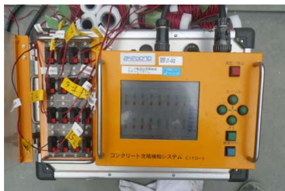
図-2. 充填検知システム使用状況
