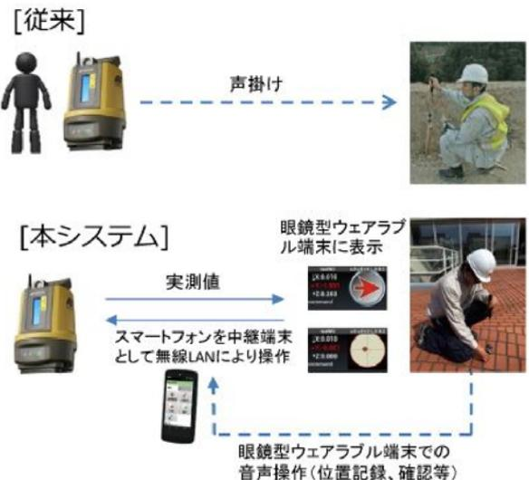
図2 従来方式と「T-Mark. Navi®」との比較
