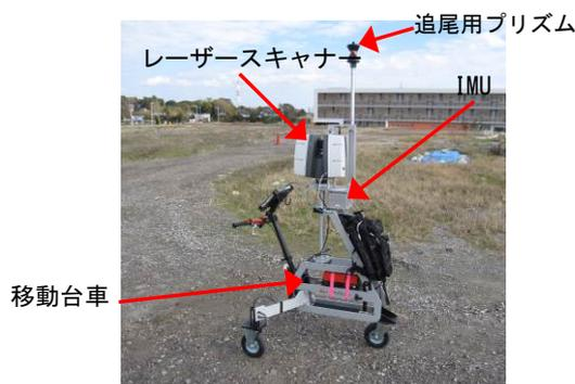
図.1 ProScan 機器構成
