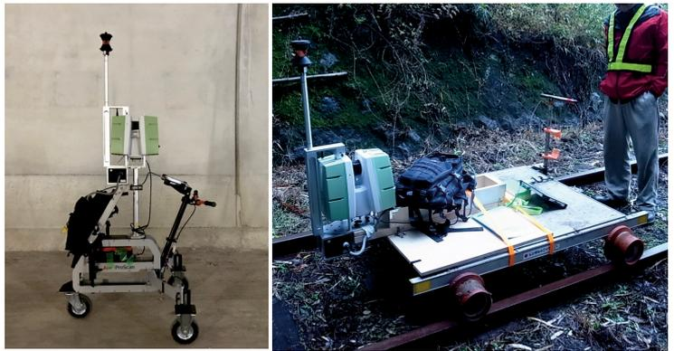
写真-1 計測機器（左：車輪付き台車，右：軌道台車）
