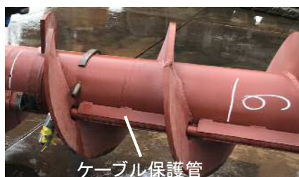
写真-1 ケーブル保護管付属スクリーオーガー
