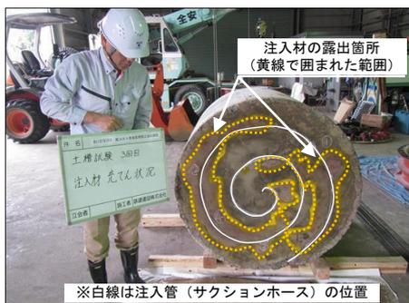
図-7 注入材充填状況 1 (CASE3)
