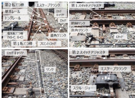
図 1 分岐器及び転換付属装置類各部の名称
