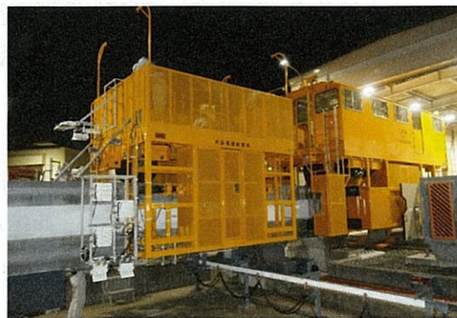
写真-2 使用車両の全景 (前：運搬作業車 後：工作車)
