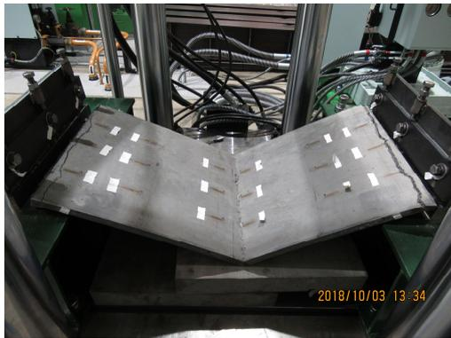
図5 試験体損傷状況
