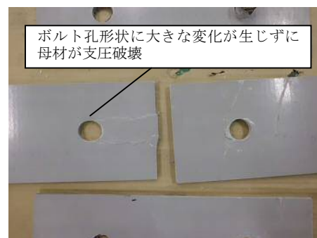
図-5 破壊状況写真 (紫外線硬化樹脂充填)
