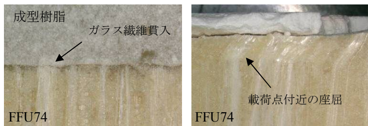
写-4 破壊部拡大写真
