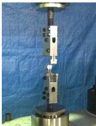
写真2 金具単体引張試験
