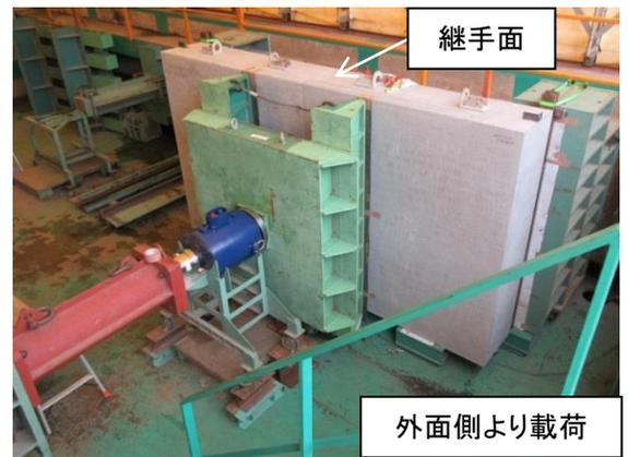
写真3 継手曲げ試験状況
