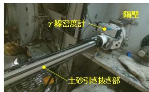
写真-1 土砂密度測定装置
