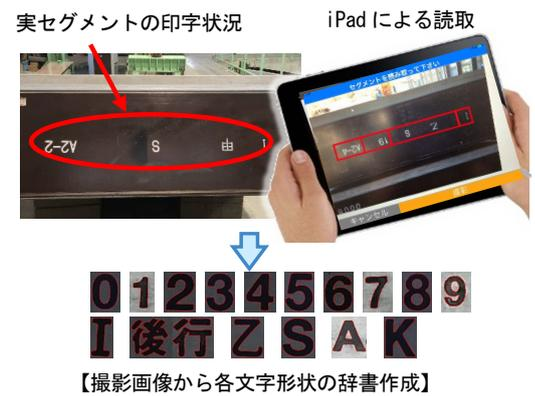
写真-1 OCRによるデジタル化
