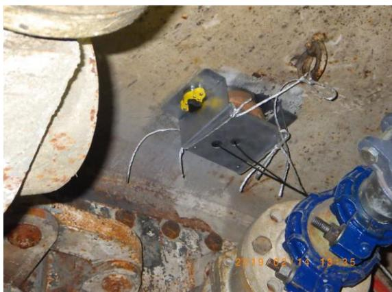
写真2. 実機へのソーナー取付状況 (外周向き)
