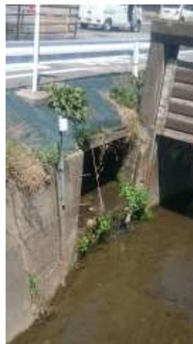
写真2 水位センサーとLPWAN実装状況
