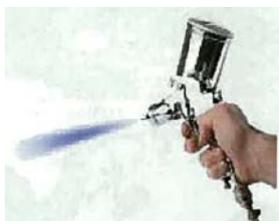
図-1 塗布型圧電素子 (スプレー式)
