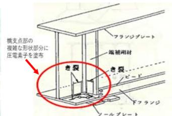
図-2 適用想定箇所 (鋼橋支点部)
