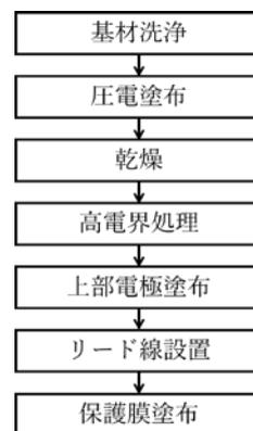
図-4 試験体作製フロー
