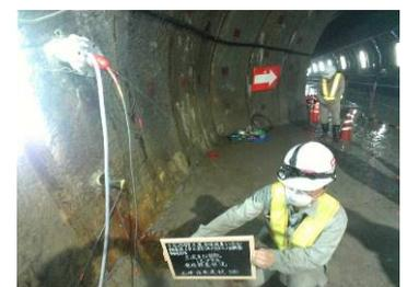
図-4 比抵抗トモグラフィ注水状況
