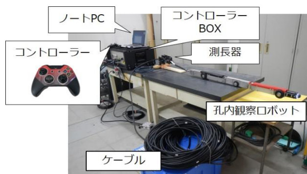
図 2 孔内観察ロボットの機器一式
