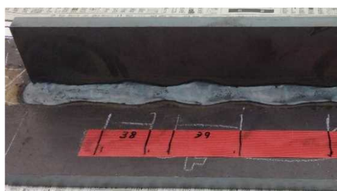
図-2 製作した溶接鋼材 （ビード高低差）
