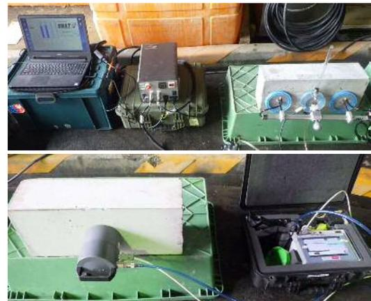
写真-3 表面吸水試験・表層透気試験状況
