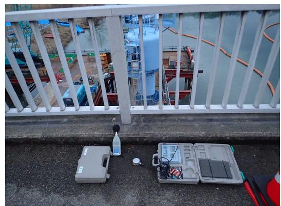
図－6 既設橋脚上での振動騒音測定
