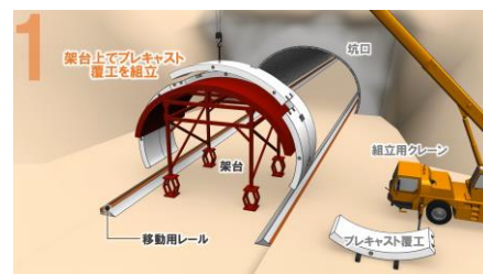
① 坑外での組立て
