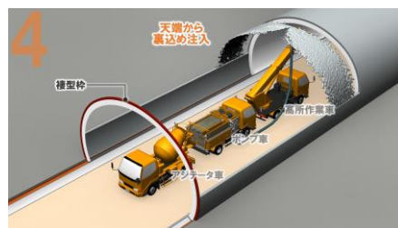
④ 覆工の完成
