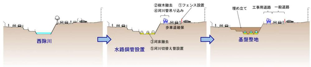
図-1 河川の置き換え、基盤整地までのステップ
