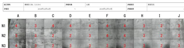
図-4 AI 画像診断に基づく評価結果の例
