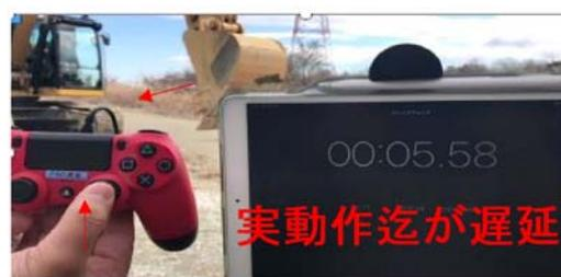
図-4 建機制御データ伝送遅延計測
