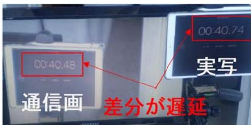
図-3 車載画像伝送遅延計測
