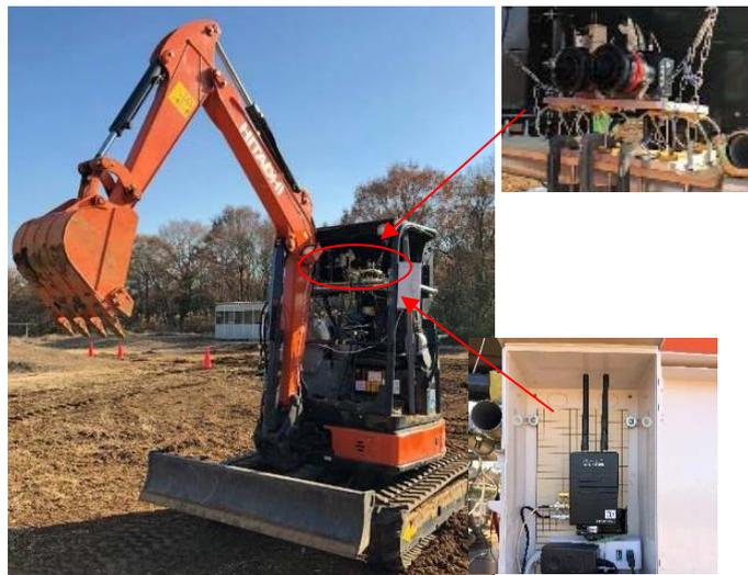
図 2 遠隔制御に用いた重機
