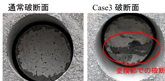
写真-3 下地処理方法による破断面の違い
