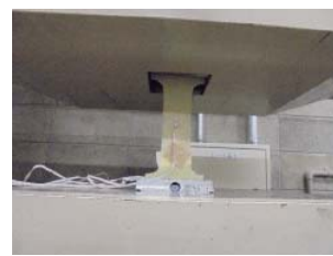
図-3 引張試験状況
