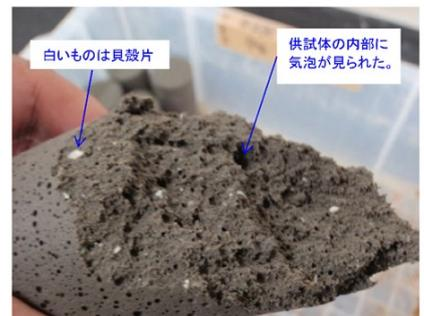
これを踏まえ、薬液中の反応剤を除去し拘束圧をかけてサンプルを養生し、体積膨張を抑制して追加試験を実施した。しかし膨張対策を施した追加試験でも、長期強度低下傾向が見られた。これは扇島が臨海工業地帯から排出された鉍滓の処理を兼ねて造成された人工島であり、サンプル内の鉍滓の膨張により微細なクラックが発生していたと推定した（図-3）。
