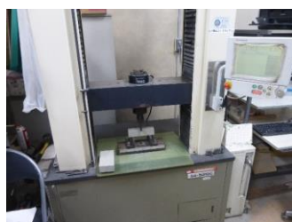
図-6 曲げ強度試験状況
