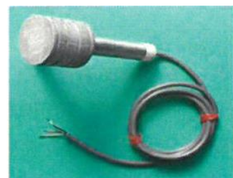
図-10 腐食度センサ
