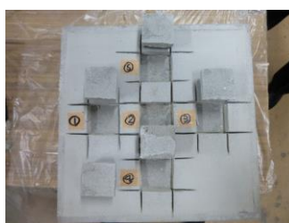
図-7 付着強度試験状況
