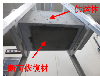
図-8 断面修復材塗布後
