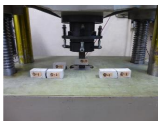
図-5 圧縮強度試験状況
