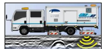
図-1 空洞探査車と取得データ例
