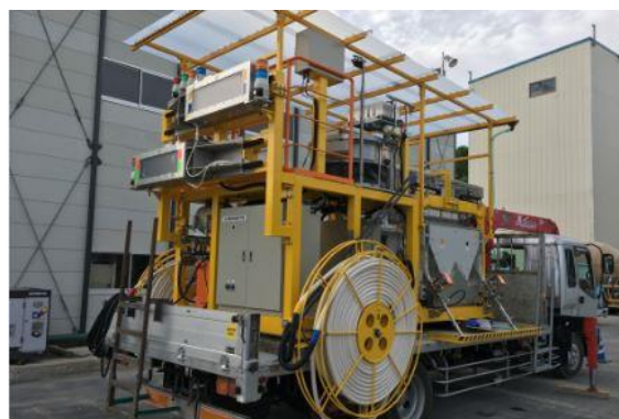
図-1 4連装の爆薬遠隔装填システム
