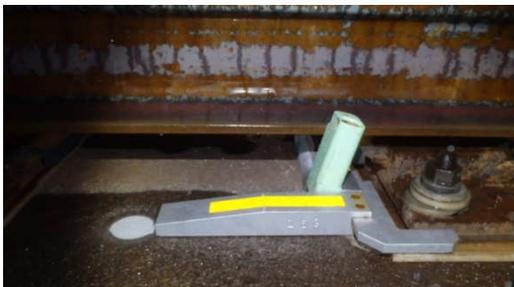
写真-3 レール持上げローラー：アゲレール
