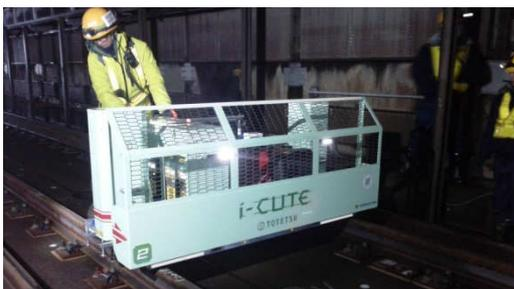
写真-4 多頭式ボルト緊解機：i-CUTE
