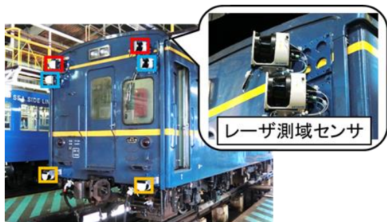
図 1 レーザスキャナの取り付け状況
